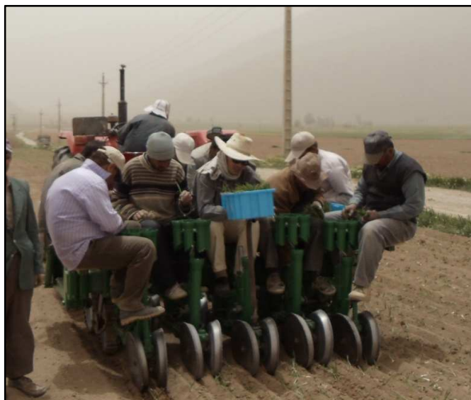
شکل ۴- ماشین نشاکار ۹ ردیفه در حین نشاکاری
