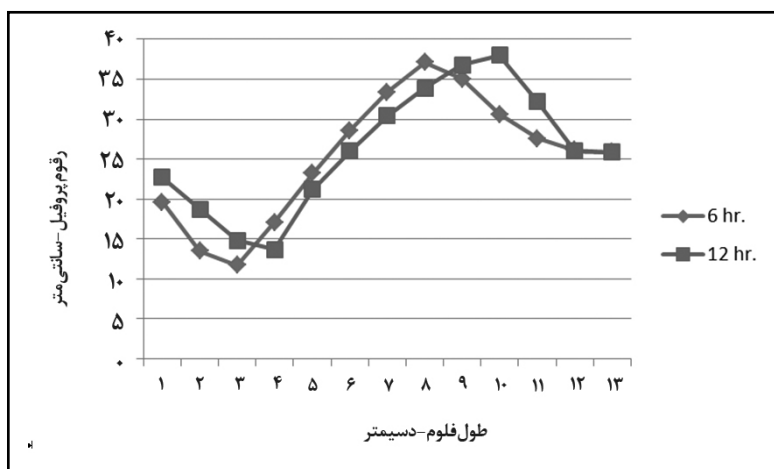
شکل ۳- مقایسه پروفل آبخستگی دو آزمایش مستقل در زمان های ۶ و ۱۲ ساعت.
