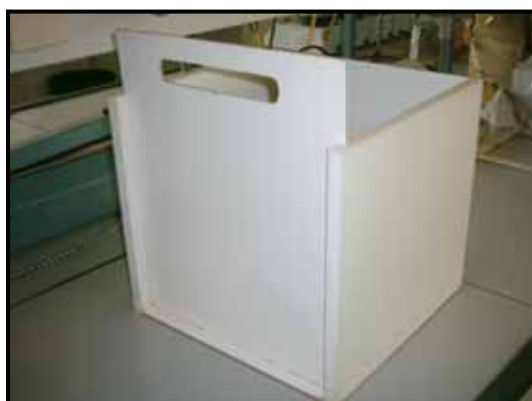
شکل ۳- وسیله مورد استفاده برای تعیین زاویه قرارگیری
