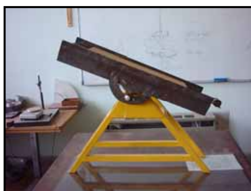
شکل ۴- وسیله مورد استفاده در تعیین ضریب اصطکاک استاتیکی
