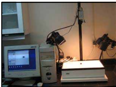
شکل ۱- دستگاه مورد استفاده برای اندازه‌گیری مساحت سطوح تصویر شده
