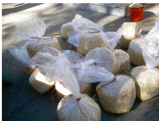
شکل ۳- عمل‌آوری و تهیه نمونه‌های کاه به شیوه رایج (در آزمایشگاه)
