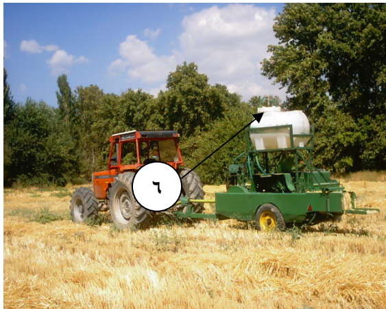
شکل ۲- نمای دستگاه غنی‌ساز کاه غلات: ۱- پمپ پاشش محلول، ۲- پایه (شاسی)، ۳- محفظه نگهدارنده مخزن، ۴- نازل‌های پاشش محلول، ۵- سیستم انتقال نیرو، و ۶- مخزن محلول اوره (Younesi Alamouti, 2006)
