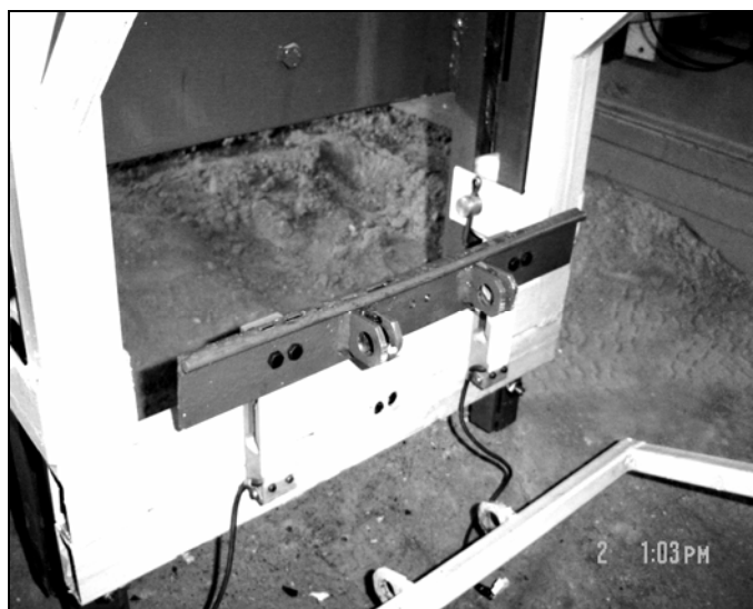
شکل ۳- تصویر قاب نگهدارنده بارسنج‌ها پس از اتصال به شاسی اصلی
