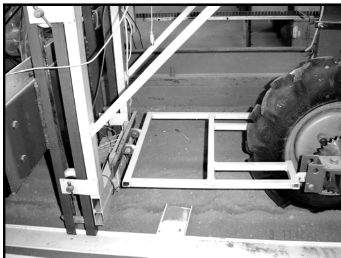
شکل ۲- تصویر شاسی انتقال دهنده نیروی گیرایی خالص چرخ به بارسنج‌ها
