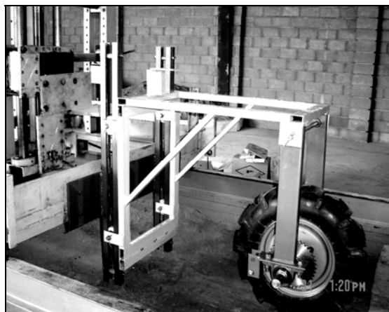
شکل ۱- تصویری از شاسی اصلی آزمونگر، بازوهای نگهدارنده چرخ و نحوه اتصال به ارباب انباره خاک قبل از نصب موتور، جعبه دنده، و سایر ضمایم
