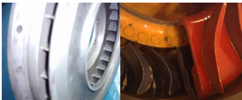
شکل ۲- تصویر سمت راست نمونه برش‌خورده و تصویر سمت چپ پمپ مبدل گشتاور لودر ۹۵۰ کاتریپیلار است.
