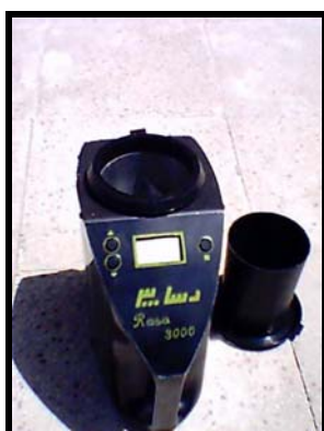
شکل ۴- دستگاه رطوبت‌سنج دانه
