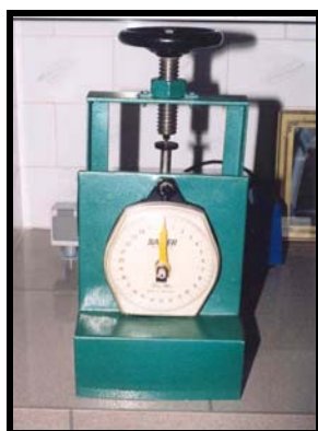
شکل ۶- دستگاه مقاومت سنج
