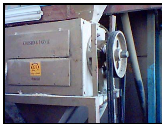
شکل ۱ - دستگاه سفیدکن سایشی افقی
