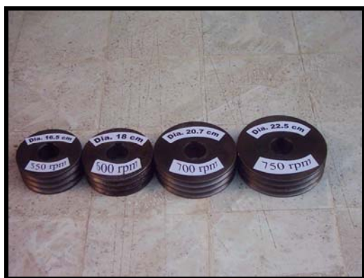
شکل ۲ - پولی‌های دستگاه الکتروموتور
