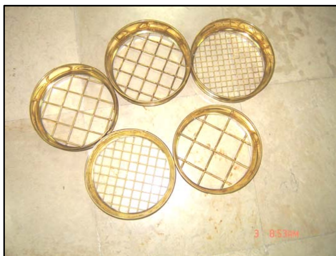
شکل ۳- الک‌های مورد استفاده برای تعیین میزان خردشدگی خاک
