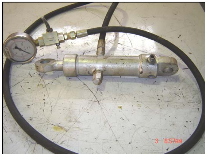
شکل ۴- دینامومتر هیدرولیکی جهت سنجش مقاومت کششی
