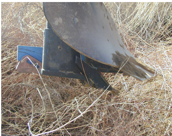
شکل ۱- وضعیت قرار گرفتن بازوی قلمی در پشت خیش
