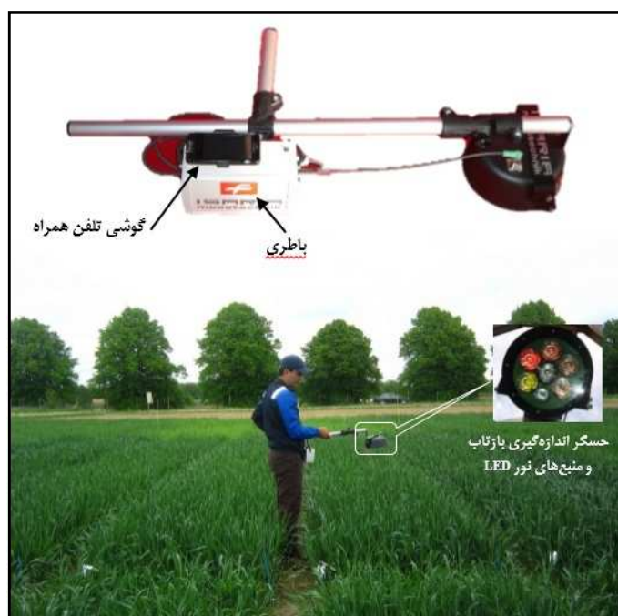
شکل ۲- اندازه‌گیری‌های غیرمخرب با استفاده از حسگر ISARIA
