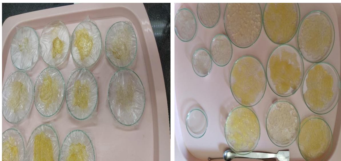
شکل ۲: نمونه‌های پکتین استخراج شده به کمک سامانه فیلتر تحت خلأ Figure 2: Samples of pectin extracted using the vacuum filtration system
